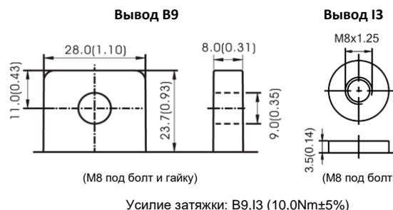
Усилие затяжки: B9,I3 (10,0Nm±5%)
